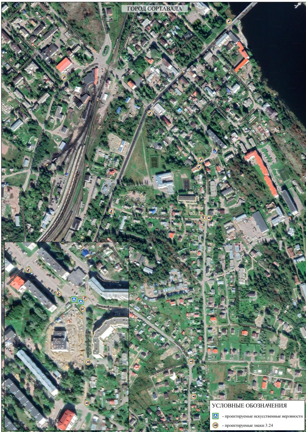
Рисунок 4.15.1 – Схема установки дополнительных знаков ограничения скорости и искусственных неровностей
