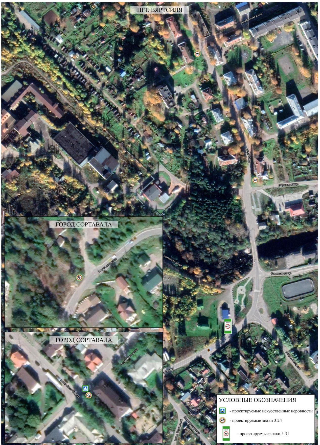
Рисунок 4.15.2 – Схема установки дополнительных знаков ограничения скорости и искусственных неровностей
